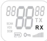
Pokud je přístroj zapnutý a nevysílá, nachází se vždy v modu příjmu. Když na nastaveném kanálu a CTCSS přjmete signál, zobrazí se na displeji symbol RX.
